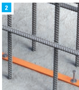
2 Zamocować za pomocą gwoździ co 25-30 cm
